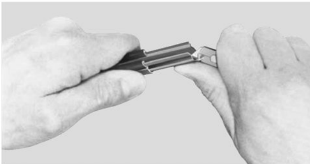
Рис. 9: Снятие фасок с помощью ножа для удаления заусенцев
